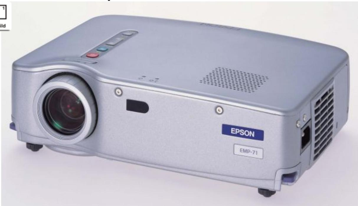
Der Epson EMP 71 LCD Beamer hat 1000 Ansi-Lumen einen Kontrast von 300:1 und eine XGA 1024 x 768 Auflösung.
